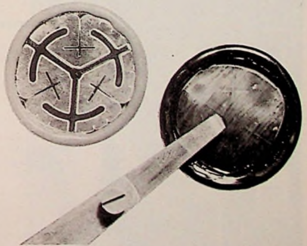
fotobijchrift: meting van „hot spots“ met vloeibare kristallen.
